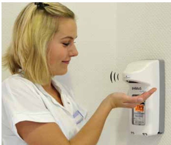
Abbildung 1: IHMoS ist ein System, das mithilfe modifizierter Händedesinfektionsmittelspender, die mit einer hochmodernen Funktechnologie ausgerüstet sind, Informationen über die Betätigungsanzahl und -zeitpunkte an einen zentralen Empfänger weiterleitet.
